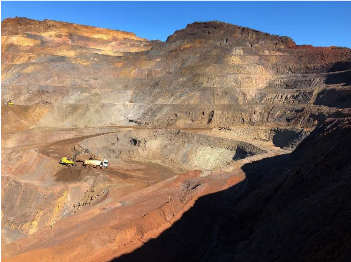
Figura 21 - Foto mostrando o conjunto escavadeira / caminhão basculante normalmente empregado na frente de lavra.
