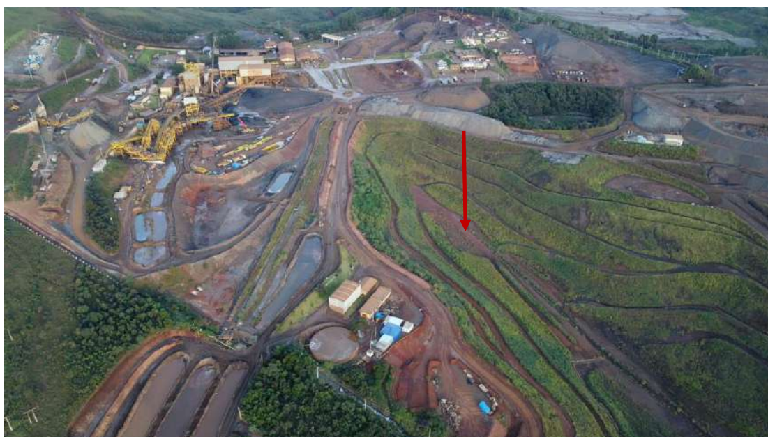
Figura 34 - Vista aérea panorâmica da área do empreendimento da Herculano Mineração no Tanque Seco, em destaque, a área da Barragem B1, já oficialmente descaracterizada, destacando-se sua total reconformação, com a retirada dos rejeitos remanescentes, implantação de sistema de drenagem e revegetação.
