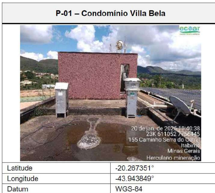
Figura 168 - Ponto de medição com os instrumentos para medições de partículas atmosféricas.
